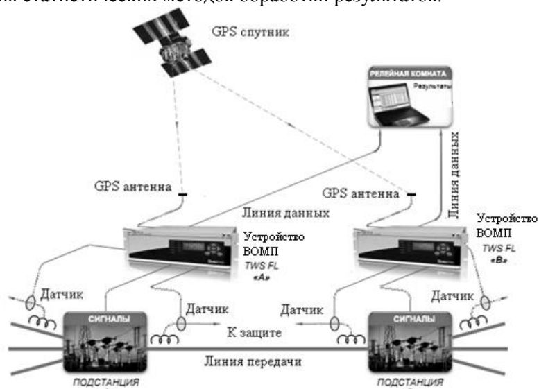
Рис. 1: Схема подключения ВОМП на примере Qualitrol TWS FL-8 [5]
